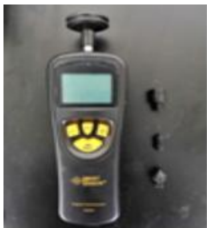
图S2 接触式高精度转速表
