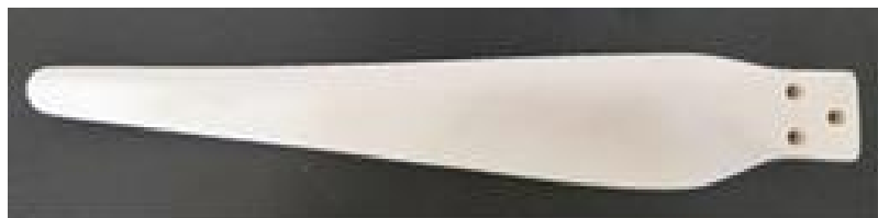
图 S1 风力机叶片微缩模型成品
