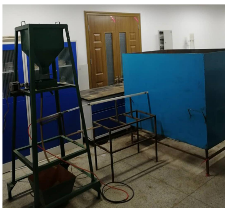
图 S4 气流挟沙喷射冲蚀磨损试验台 XS-40
