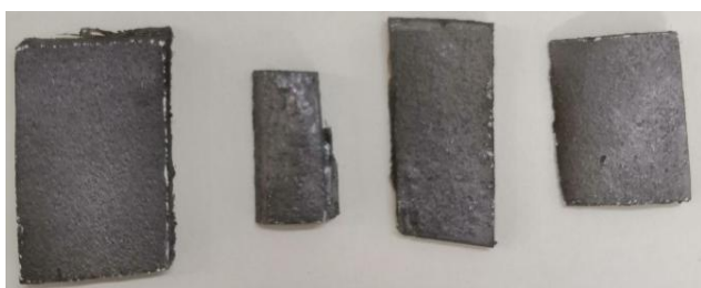
图 S5 喷金后的涂层试样
