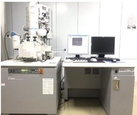
图 S3 场发射扫描电子显微镜
