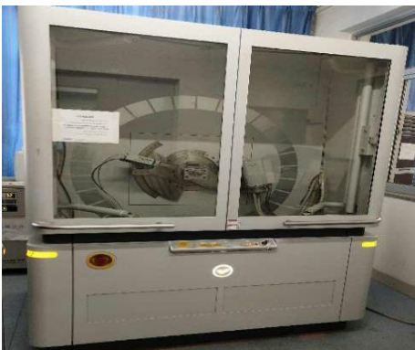
图 S4 X 射线衍射仪
