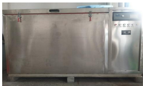
图 S1 干湿循环试验机
