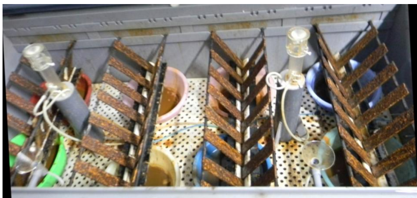
图 S1 盐雾箱内试件摆放形式图
