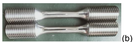
图 S1 FGH96 合金试样: (a)形状尺寸(mm), (b)实物
