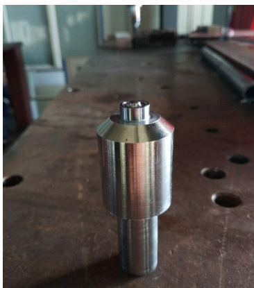
图 S2 钨铼合金搅拌头 Fig.S2 The W-Re stirring tool
