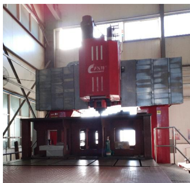
图 S1 FSW-LM2-1020 型搅拌摩擦焊接设备
