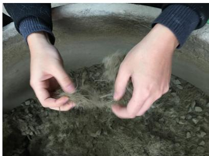
图 S3 捻散在混凝土中结团的纤维
