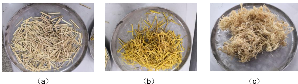
图 S1 稻草纤维的形貌: (a) 原生态稻草纤维; (b) 改性杆状稻草纤维; (c) 改性丝状稻草纤维
