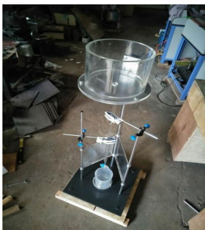
图 S2 湿泡沫沉降距、泌水率测量仪器
