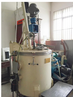
图 S2 腐蚀试验装置主体部分 Fig. S2 The main part of corrosion test equipment
