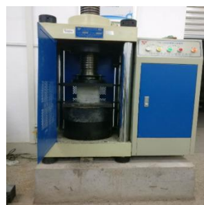
(c) 混凝土试样抗压强度试验
