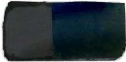
图 S3 磨角染色后的硅片样品
